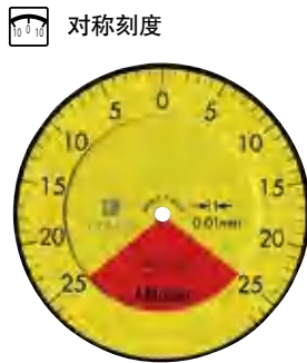
分度值：0.01mm， 测量范围：0.5mm 2971TB ☑ 单转型 ☑ 防震型 ☑ 防尘型
