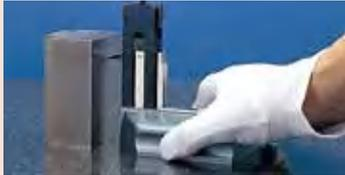
使用底座，一个支架和划线器尖爪给工件划线
