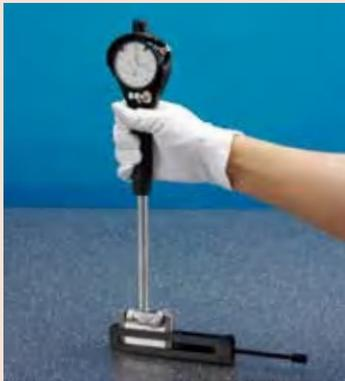
使用支架，一对 I 型的半圆量爪作为平台来校正孔径表。
